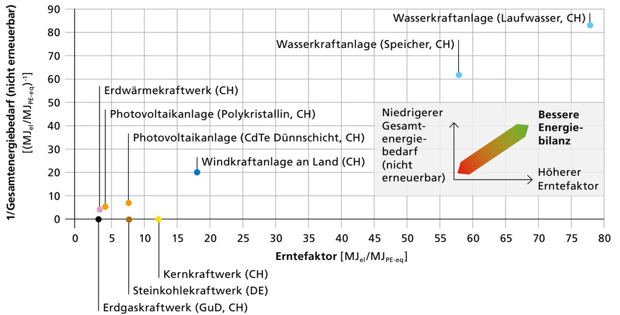
**Abbildung 1:** Die Gesamtenergiebilanz, ermittelt aus den Kennzahlen «Gesamtenergiebedarf (nicht erneuerbar)» und «Erntefaktor (EROI)», zeigt ein deutliches Bild: Die Wasserkraft schlägt alle übrigen Arten der Stromerzeugung um Längen. Doch auch Photovoltaik und Windkraft schneiden gut ab.
